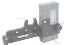
1. Установите приемник в кронштейн таким образом, чтобы направляющий выступ на кронштейне был совмещен с выемкой на задней стороне приемника.
